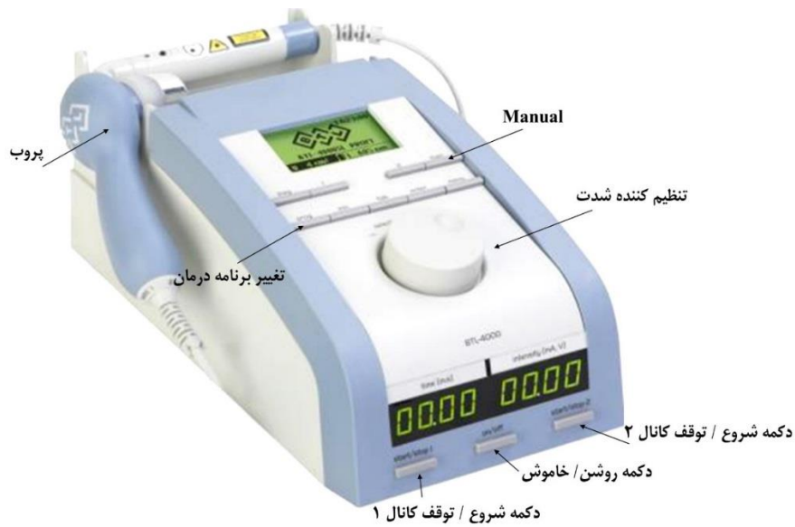
شکل 3 دستگاه فراصوت برای کاربرد های درمانی
